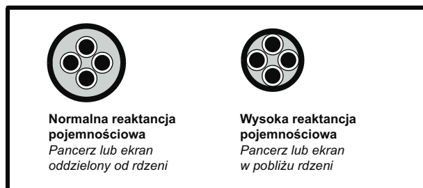
Rysunek 4-17 Wpływ konstrukcji kabla na reaktancję pojemnościową
