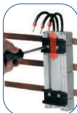
Ustaw szynę montażową w odpowiedniej pozycji i dokręć wkręty
