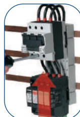
1. Umieść komponent APASYS 60 na górnej szynie montażowej i podłącz zasilanie 2. Umieść drugi komponent na dolnej szynie montażowej. Przesuń szynę montażową aby dopasować położenie komponentu i podłącz go
