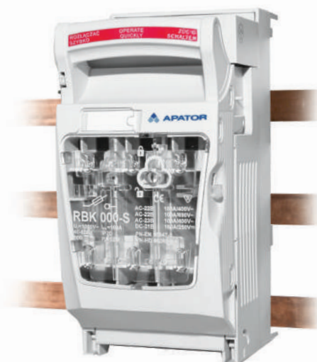
RBK 000 pro-SG (odejście kablem z góry) RBK 000 pro-SD (odejście kablem z dołu) wykonanie do montażu na szynach zbiorczych na rozstaw 60 mm
