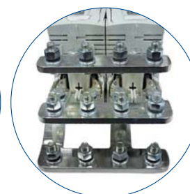
Kabelanschluss des 4M Typs: vier M12 Einpressmütter pro Phase
