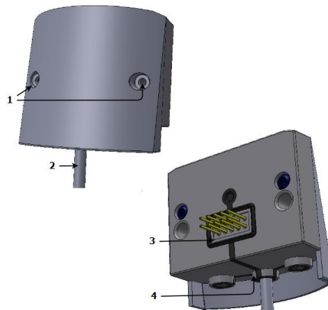
Rysunek 6. Budowa modułu APT-ELF2-USB-1
