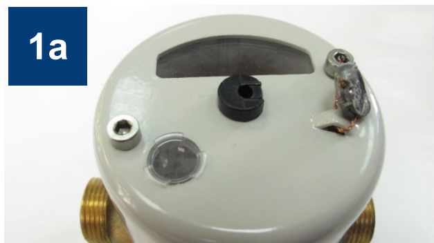
Wodomierz typu JS4-NK . Liczydło IP65 wyposażone jest w oprawę z jednym magnesem, zamontowaną w położeniu wskazówki (x0,001) → impulsowanie 10 l/imp.
