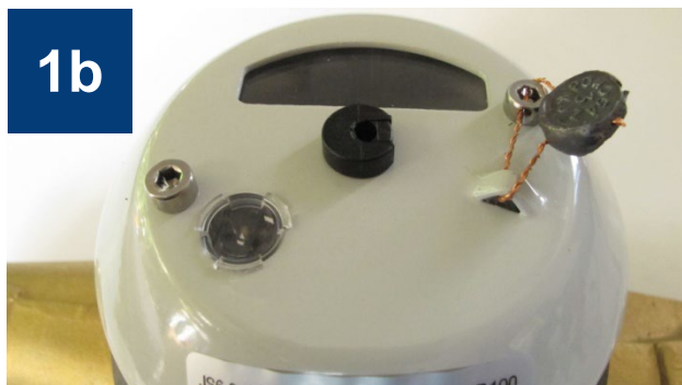
Wodomierz typu JS16-NK . Liczydło IP65 wyposażone jest w oprawę z jednym magnesem, zamontowaną w położeniu wskazówki (x0,01) → impulsowanie 100 l/imp.
